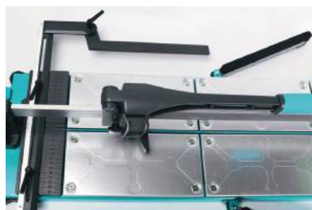
5. Podesive vodilice za rezanje pod kutom 0° i 45°
